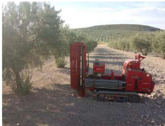
Fotografía 3. Realización de ensayos DPSH.
