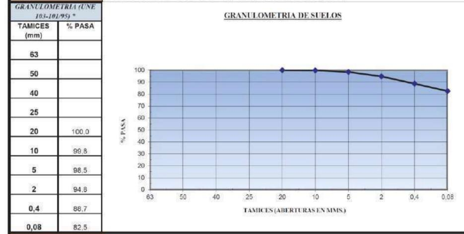
PROCEDENCIA: SONDEO 1. MUESTRA INALTERADA DE 2,40 A 3,00 M DE PROFUNDIDAD
