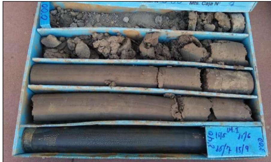
Fotografía 4. Nivel correspondiente a arcillas con vetas de arenas-limos
